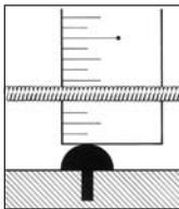
弦高調整はブリッジ本体またはブリッジサドルの高さを変化させて調整します。また、ネック調整やゲージの異なる弦への交換後も弦高の再調整が必要です。
